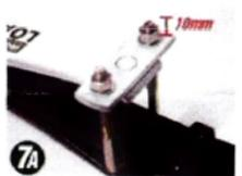
Pour un véhicule chargeant plus de 400 kg vissez les écrous sur un longueur de 40 mm.
