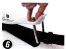
Pour un véhicule chargeant moins de 400 kg vissez les écrous sur un longueur de 10 mm.
